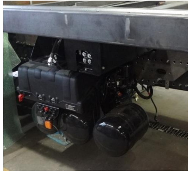
Werkzeugkästen und Ablagewannen werden auf Istmaß angepasst
