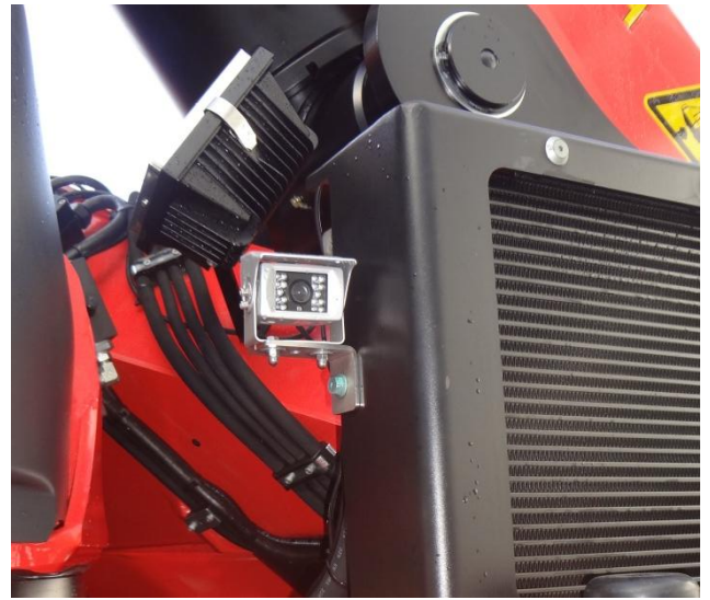
Kamera in 2-facher Ausführung für Anhängerbetrieb und Rückansicht
